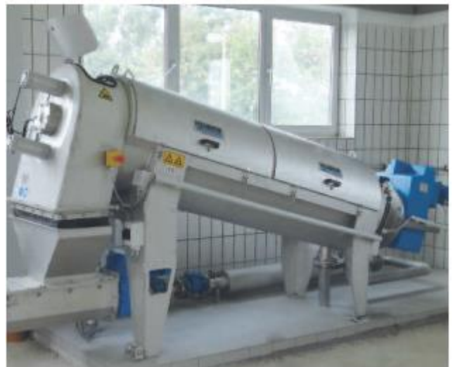
Stacionariai sumontuotas sraigtinis presas, apdorojantis 140 kg SM /h.
