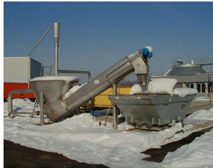
COANDA smėlio plovimo įrenginys RoSF 4 su apsauga nuo užšalimo
