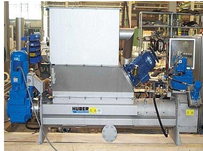
Nešmenų plovimo presas WAP/SL/HP su intensyvaus plovimo įrenginiu ir hidrauliškai valdoma presavimo zona
