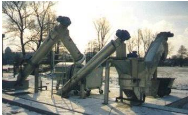
ROTAMAT® pilnutinio valymo įrenginys Ro 5, sumontuotas po žeme, su apsauga nuo užšalimo
